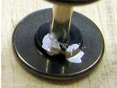
Bei beidseitig isolierten Achsen (z.B. Fa. Luck), muß auf der anderen Seite bzw. Radscheibe unbedingt eine Verbindung zwischen Achswelle und Radscheibe hergestellt werden!
